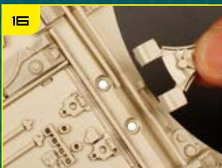
16 Зафиксируйте деталь 10 с помощью клея и вновь закрепите деталь 1 с помощью магнитов.
