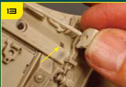
13 Вставьте второй конец детали 8 в отверстие в детали 9. Деталь 9 крепится в указанном квадратном гнезде.
